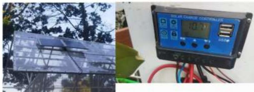
**Gambar 4.** Solar panel yang telah terhubung dengan SCC
