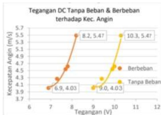
**Gambar 9.** Grafik Tegangan Tanpa Beban dan Berbeban
