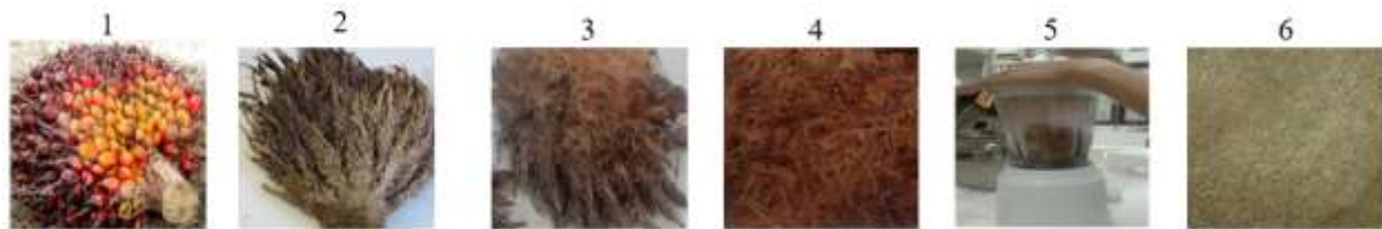
1) Tandan Buah Segar; 2) TKKS Kring; 3) Proses Pematangan TKKS; 4) TKKS setelah di Kecilkan; 5) Proses Penggilingan TKKS; dan 6) TKKS setelah Penggilingan.
