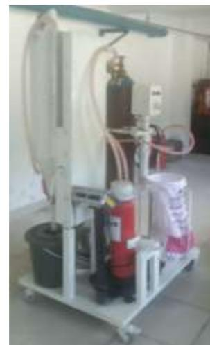
Gambar 2. Prototipe Alat Pengisian APAR
