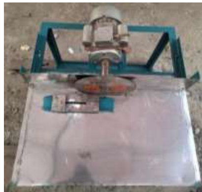
Gambar 5. Proses Pemasangan Motor Listrik Sumber: Analisa data pada lapangan
