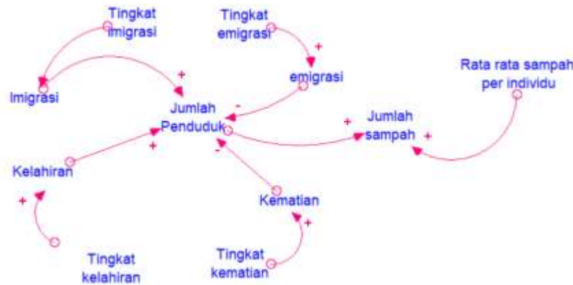
Gambar 1. Diagram causal loop proyeksi timbulan sampah mengandung B3 Sumber: Analisis, 2024
