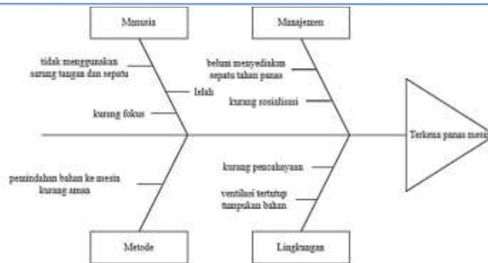
**Gambar 3.** Fishbone Diagram Terkena Panas Mesin
