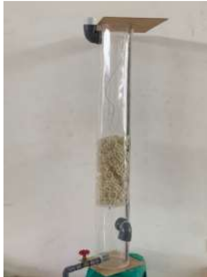
Gambar 2. Rancangan Reaktor Wet Scrubber Asli Sumber : Dokumentasi (2024)
