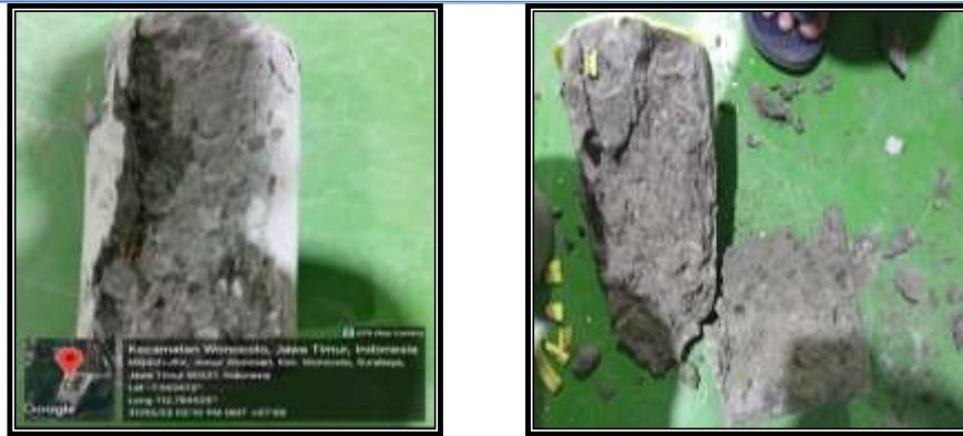
Gambar 5. Hasil Pengujian dan Bentuk Kehancuran Kuat Tekan Beton Sumber: Pribadi (2023)
