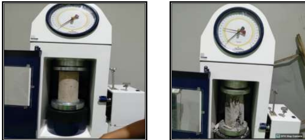
Gambar 3. Setting Up dan Hasil Pengujian Kuat Tekan Beton Sumber: Pribadi (2023)
