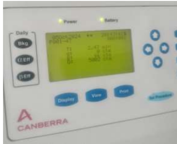
Gambar 2. Hasil Pencacahan Radiasi dalam Sampel E-Liquid menggunakan Multi Channel Analyzer Sumber: Dokumentasi penelitian (2024)
