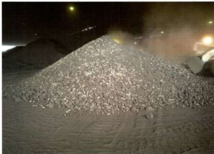
Gambar 1. Pencampuran batu bara dan tongkol jagung kering di dry coal site
