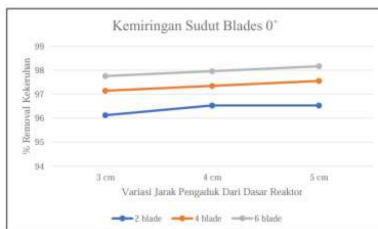
Gambar 10. Pengaruh Jarak Pengaduk Dari Dasar Terhadap Penurunan Parameter Kekeruhan
