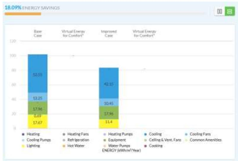
**Gambar 2.** Hasil Modeling Penghematan Energi menggunakan EDGE
