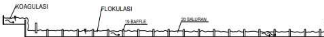
Gambar 5. Tampak Unit Koagulasi dan Unit Flokulsi Sumber : Analisis,2025
