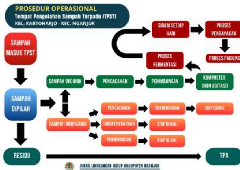
Gambar 3. Skema Prosedur Operasional Pengelolaan Sampah TPST Kartoharjo
