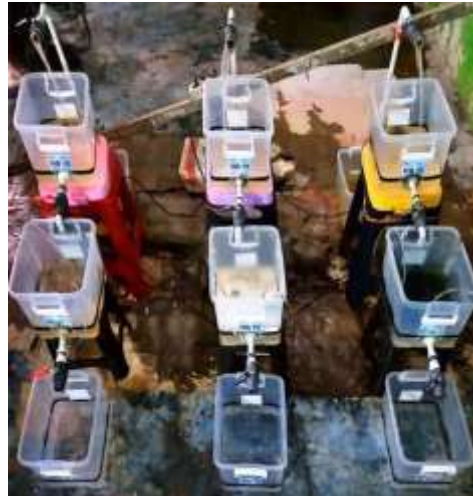
Gambar 5. Proses Biofilter Aerobik Sistem Kontinu
