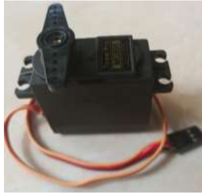
Fig. 4: MG-995 gear servo motor
